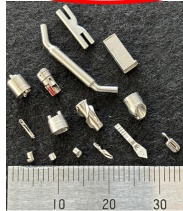
3Dプリンターで作った金属部品
