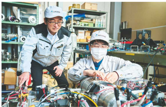
水素混焼タービン発電機を搭載した大型ドローンのモデル機。バッテリーのみでは航続距離に限られるが、バッテリーよりもエネルギー密度が高い水素混合燃料を使用するため、長距離飛行が可能に。
