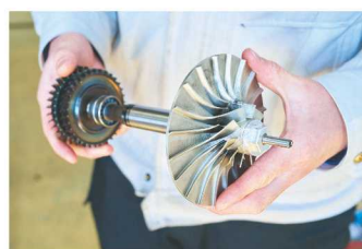
水素混焼タービンエンジンの回転ユニット。燃焼後、高温になるタービン動翼(左側パーツ)には、耐熱性の高いインコネル合金を使用している。YSECが持つ難削材の高精度切削技術が加工に活かされている。
