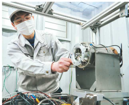
開発室には専用の燃焼試験施設「エンジンテストセル」を備え、発電機の性能テストを実施。
