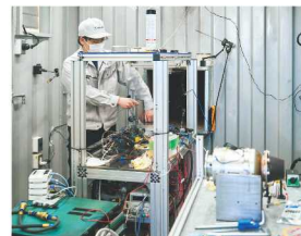
開発室には専用の燃焼試験施設「エンジンテストセル」を備え、発電機の性能テストを実施。
