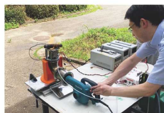
新潟大学工学部の山縣准教授を中心に、燃焼テストを実施。水素の混ぜ方を何パターンか試し、その効果を立証した。
