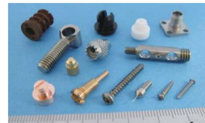
φ50以下の複合NC旋盤加工
