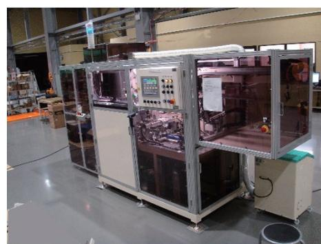
図 1 自動車部品画像処理自動検査機
