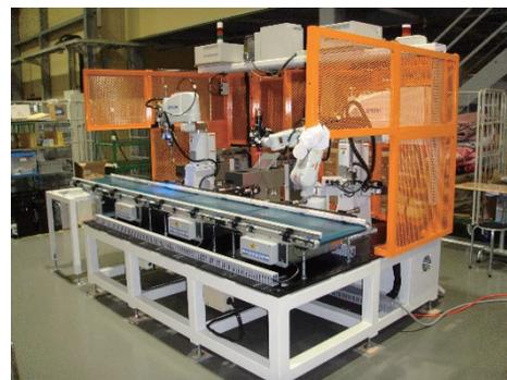
図 2 暖房器具画像処理追従型自動組立機
