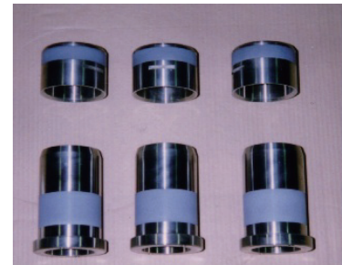
↑スリーブ (セラミック溶射)
