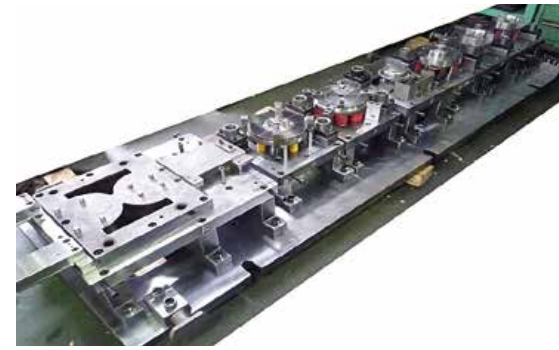
長さ2300mmの金型、社内でプレストライ可能!
