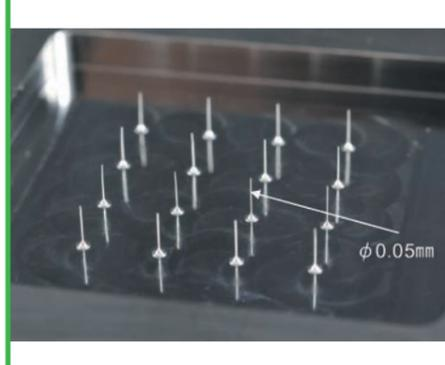
64チタン微細切削加工(削りだし)
