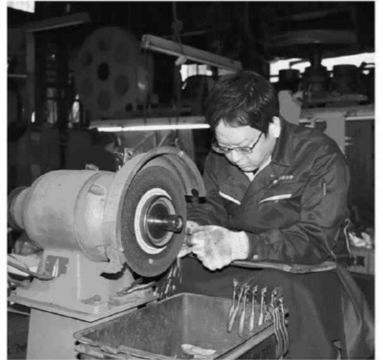
爪切りの刃を合わせるため、研磨する古沢製作所の職人=三条市
