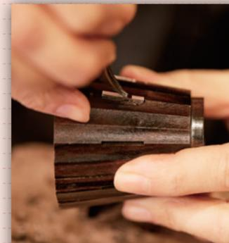
木取り、荒削り、研磨、塗装が基本工程。レーザー加工した深さ1.4mmの溝に銀を打ち込む緻密な作業もある。
