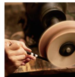
職人の手技が光る研磨作業により、シャープな箸先が作られる。初代の仏壇彫刻の技術と精神が受け継がれている。
