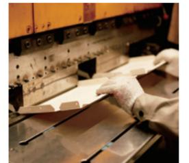
成型の工程。紙といえども硬い素材なので金属のようにプレスする。
