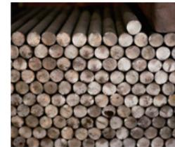
同社製品の多くは(株)神戸製鋼所に特注した独自の鋼材「マルトロイ」を使用。高い硬度が得られ、抜群の切れ味と耐久性を生む。ネイルニッパーは3~5万回使っても切れ味が持続する。
