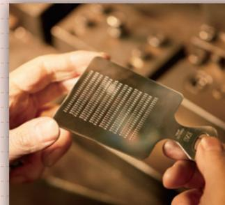
おろし金の歯を起す作業。どんなに機械が進歩しようが切れ味を求めたら人間の感覚の方が良い。設置する高さが薄紙一枚でも切れ味は変わるので、職人の経験と繊細な感性が必要だ。
