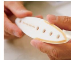
最初に開発したペーパーナイフ。カットした刃の部分が焦げ、年輪のようにになっている。切れ味が悪くなったらサンドペーパーで研げばまた切れる。焦げ痕も次第に薄くなり、使い続けるうちに味が出る。
