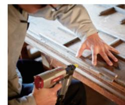
接合部に補強のための「隠し釘」を打つ。最後は外枠で見えなくなる部分だが、針ほどの細さの釘を丁寧に打ち込む
