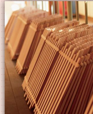
塗装する前の状態で、一度水に浸して乾かす。木を安定させ、細かい傷を浮き上がらせるための「水引き」という工程。
