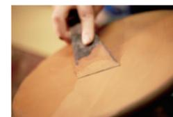
下地の砥の粉をヘラで塗り付けたのち、漆を何度も塗り重ねていく。乾燥時間が短いと落ち着いた色に、長いと鮮やかに発色する。
