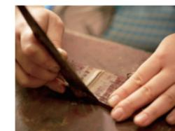
繊細かつ迷いのないヘラさばき。漆を盛り上げ竹の節を表現する「竹塗」の重要な工程。変塗には他に100通りもの技法があるとされる。
