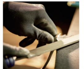
左右の刃をピッタリと合わせる合刃調整の工程。確認にルーペを使うほど微細で難易度が高い。職人の中でも熟練した「爪切りの神様」たちが手でやすりをかけて調整する。
