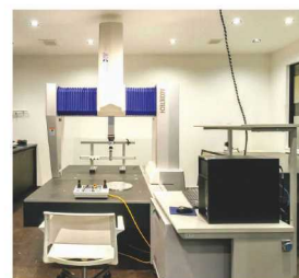
高精度CNC三次元座標測定機を備えた検査室。最新の品質評価測定設備によって、高い精度が求められる品質検査に対応。測定時間を短縮し、複雑な形状の部品も測定できる。
