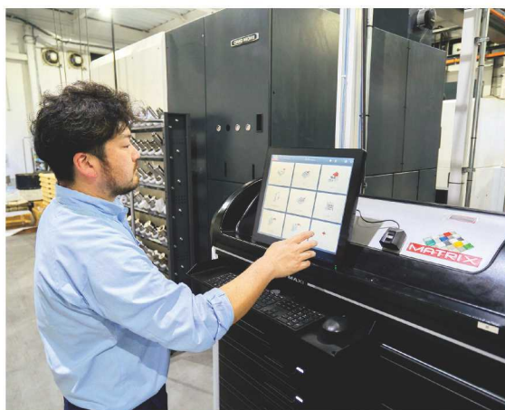
白倉代表が自らメーカーを訪れ、2020年に県内で初めて導入したタンガロイ社の工具管理システム「MATRIX」。指紋認証をしてタッチパネルで情報を入力すると、加工に必要な工具の位置を教えてくれる。
