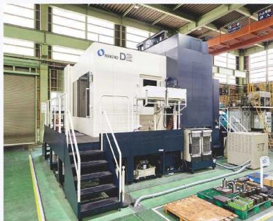
2022年に大型部品用金型製造に対応する大型マシニングセンタの工作機械マキノD-2を導入。2,000t超の大型ダイカスト金型を安全かつ効率的に製作できる。
