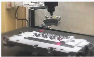
3次元測定機で製品や金型の寸法を測定し、求められる品質を維持。
