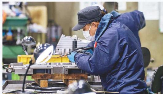
米谷製作所は鋳造金型の設計・製造、金型の完成度向上につなげる各種解析などにより業界をリード。金型の最終工程は職人の手で磨いて仕上げられる。また高レベルのQCD(品質・コスト・納期)により競争力を高めている。CAD/CAMといったIT技術を40年以上前から導入し、顧客の高い要求に応える金型を高品質・短納期で製作することで技術と経験を蓄積してきた。
