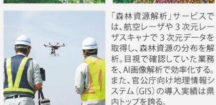
「森林資源解析」サービスでは、航空レーザや3次元レーザスキヤナで3次元データを取得し、森林資源の分布を解析。目視で確認していた業務を、AI画像解析で効率化する。また、官公庁向け地理情報システム(GIS)の導入実績は県内トップを誇る。
