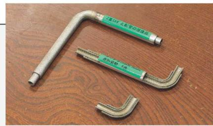
金属3Dプリンターで造形したサンプル。液体水素を運ぶ真空断熱の2重配管をヒントにより小型の2重配管を試作した。金属3D積層造形の課題も見え、今後は溶接などの技術と組み合わせることで特殊な構造の加工が可能という提案ができる。
