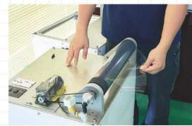
フィルム素材を非接触で搬送できる「浮上ロール」と、サクションマーク(吸い込み跡)なく吸着できる「サクションロール」により、フィルムの向きを自在に変更し、どの部位でも固定が可能。工場ラインの省スペース化を実現する。
