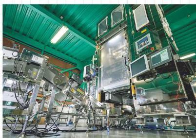
固形物が入った液体・粘体食品を充填することができる自動充填包装機「GANSHIN」。粉碎含浸用包装フィルム「ERフィルム」や、充填時に固形物のかみ込みを防ぐ、特殊なヒートシール方法「粉碎含浸®シール」を開発し、より生産性の高い、安定した製造ライン構築する。
