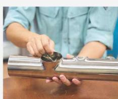
1mm厚のチタン板を溶接したパイプ。バーリング加工(穴あけ部分を立ち上げる加工)とバフ研磨は協力企業に依頼。小林製作所の精密溶接技術と他社が持つ技術が連携し、高いレベルの製品提案・アピールにつなげている。
