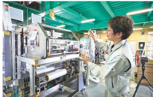
オートスプライサーはエッジセンサを用いて新旧のフィルム原反を自動で調整、熱圧着するため、新しいフィルム原反を交換部にセットしておけば自動的に交換できる。フィルム原反の交換に伴うロスを削減。
