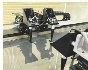
薄く破損しやすい基板などを、浮上ユニットで浮き上がらせ接触することなく吸着盤上を移動させることができる。ワークの汚染リスクを低減。
