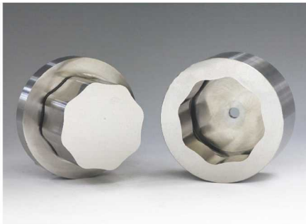
ジグ研削盤を用いて1000分の1mm単位での削りを行う。超高精度かつ耐久性を求められる自動車関連、医療用、食品用金型などにニーズがある。
