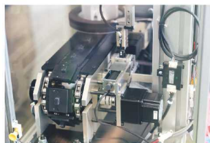
販売実績もあるAIによる自動検査装置。1台のカメラで多方面を検査できる機能を持つ。コストを抑え、100V電源でも使用できるなど導入しやすい工夫している。
