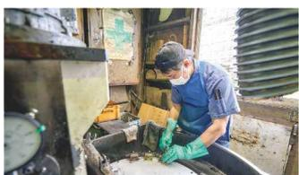
刃の研磨は機械加工での量産体制を整えつつ、最後の仕上げは熟練工による手作業。パーツ加工は協会社へ委託しながら、豊富なラインナップの大工道具を製造している。
