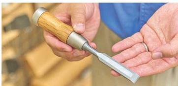
「鍛流のみ」は、西洋式の形をしながら硬い鋼と柔らかい鉄を合わせた日本式の技術で作られたハイブリッド洋ノミ。最高級刃物鋼「青紙」を使いながらも研ぎやすく、ノミの裏面は西洋式のように平らになっている(写真上)。
