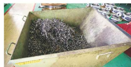
タナベでは切削加工で出た金属の切粉を洗浄・脱脂する技術による金属回収リサイクルシステムも提供している。
