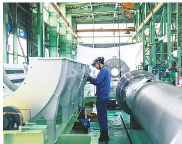
電気自動車の普及からリチウムイオン電池の原料となる特殊粉体(機能性粉体)を焼成する外熱式ロータリーキルン(回転炉)の需要が世界的に高まっており、その動きはこれからも拡大する見込み。大量の特殊粉体を製造したいとのニーズから直径1~1.4mの大型炉の注文も多い。
