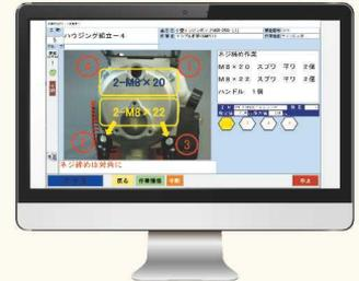
アドレックが開発したオリジナルの製造支援・履歴管理システム「デジプロマスタ」。作業手順を的確にナビゲートする機能のほか、トルクレンチと連動させることでトレーサビリティの充実化を図れるなど、生産の安定や効率化をサポート。
