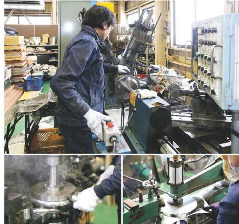
へら絞り加工から成形、トリミング、研磨、溶接まで、同社で受注した製品については社内で一貫加工ができるように、各種機械を揃えている。中ロットまでのスピニング加工も可能だ。
