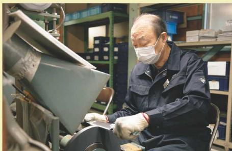
刃付けは職人の高度な技術を要する工程で、荒研ぎ・中研ぎ・仕上げ研ぎの順に刃を仕上げていく。測定した刃角度は技術継承のためのデータとしても活用される。
