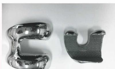
電子ビーム積層造形による人工膝関節
