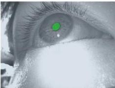
ガゾウのキー技術である視線解析システムは、眼鏡型デバイスに搭載された近赤外線カメラで眼球を撮像し、眼球運動から視線を解析。同時にまばたきも検出し、視線と組み合わせて解析することができる。顧客のニーズに合わせて、デバイスのカスタマイズも可能。
