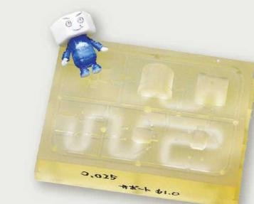
新潟工科大学と産学連携でトライアルする樹脂製金型の試作品。実用化できればプラスチック成型の可能性が広がる。
