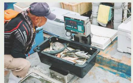
船上で水揚げした魚の重量を測定。常に変化する波の揺れの中でも計測を可能にした技術は特許を申請中だ。
