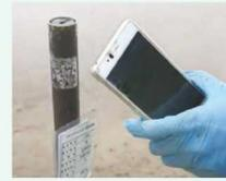
作業開始前に圃場のICタグを読み取る
