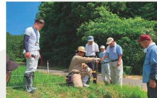
防護柵（電気柵）の機能診断も取り組みの一つ。配線不良がないか、雑草による漏電がないか、侵入ルートがないなどを調べ、柵を管理する上での注意点を農業者に伝える。
