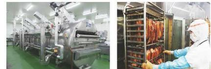
前工場の5倍以上の規模を誇る新本社工場。生産力を高めた急速冷凍機「トンネルフリーザー」(写真左)は水分を一瞬で凍らせることで旨みを閉じ込める。
