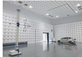
長岡市に設置された「10m電波暗室」。車もそのまま入る広さで、電気製品、医療機器などのEMC試験ができる。
