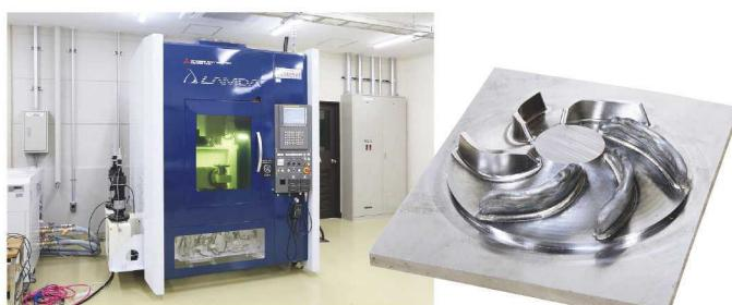
2020年に導入された金属堆積造形装置(金属3Dプリンタ)。
