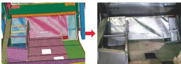
CAEによってシミュレーションされた完成品の実験結果(左)と、実際の車体を使ってROPS試験を行った結果の写真。シワの入り方まで見事に一致した。
