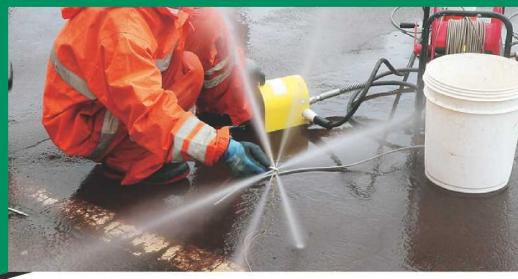
自社開発した洗浄ノズルは、垂直方向に6つの穴から水を噴出させることで、高い洗浄効果が得られる。
