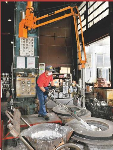
導入したエアーバランサーで、融解したアルミ合金の汲み出し作業をする様子。扱うものが高温なので、安全性も重要だ。シンプルな設備を選んだことによって、使いやすく、費用も抑えられた。
