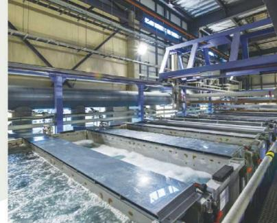
NSCA工場に導入されている表面処理設備。3メートルの自動表面処理ラインで大型部品の化成皮膜・アルマイト処理にも対応している。
