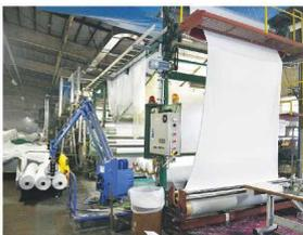
メーカーから送られてくる生機(きばた)と呼ばれる加工前の生地には、余分な油分や細かいゴミが付着している。それを洗浄する「精練」技術により、後工程で質の高い製品に仕上げられる。
