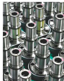
エンジンに欠かせない燃料噴射ポンプ、燃料噴射弁、燃料噴射ノズルはいずれもミクロンレベルの高度な加工技術が求められる。培ってきた経験、技術によって信頼される品質を生み出している。
