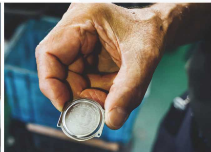
阿部製作所の強みは、長い年月の中で培ってきた精密金型の設計・製作と高度なプレス加工技術。グローバルに展開する某人気腕時計ブランドの裏蓋を、国内で唯一生産している。
