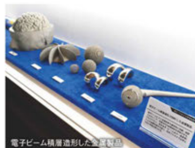
電子ビーム積層造形した金属製品
