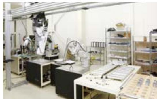
工場内に生産ラインのモデルを設置。顧客が自社の工場を想定しながら、実際にロボットがどのような作業をするのかわかることができる。これだけ多くのロボットを保有し、実験まで行うSIベンダーは例がないという。
