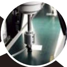
水平方向にアームが動くスカラロボットとカメラをドッキングし、画像認識で問題のある製品だけをアームがピックアップして移動。最初はバリの検査用として導入したが、ピッキング用にバージョンアップさせた。
