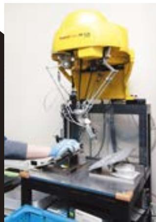
ゲンコツロボットの導入により、ワークの寸法測定、ゲージ検査が自動化された。アームは人間の手指のような繊細な動きが特徴。動作領域が本体の真下に限られるので、すぐ隣で人が安全に作業できる。
