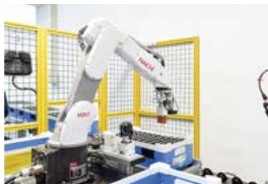
ひたすらプローブを当てて電圧を測る作業を行う6軸多関節ロボット。傾斜をつけたローラーに部品を流すシンプルな仕組みを作ることで、人が居なくても休みなく作業をしてくれる。
