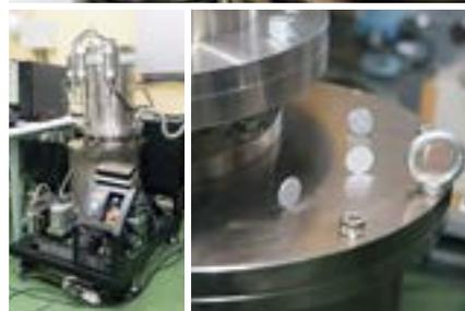
真空ポンプの心臓部にあたる「スクリューローター」と、完成品の「不等リードスクリューブスターポンプ」。スクリューは毎分7,200回転と超高速だが、驚くほどの低振動を実現している。
