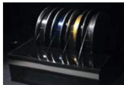
タングステンやモリブデンを中心に、各種金属・合金を伸線（しんせん）加工技術で直径10ミクロンまで細くした金属細線を製造。最高3ミクロンまで細く加工する高度な技術を持つ。
