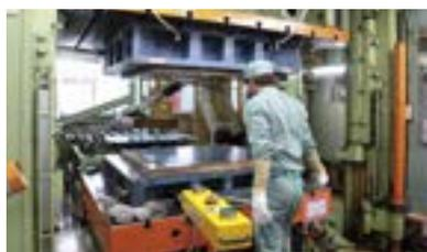
スクエア形状の「JS15L 3Fシンク」は、立体的に使うことでシンクスペースと調理スペースを同時に確保できる。この9月には、やや小型のミドルサイズも完成予定(写真上)。通常は自動車のボディなどを絞る1,200トンのプレス機で、ステンレスシンクの絞りを行う。充実した設備と技術力が、他社では真似のできない製品を生み出している(写真下)。
