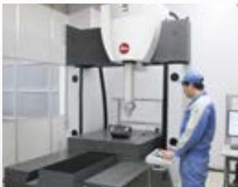
サポイン事業で導入したライツ社の超高速、超高精度三次元測定機。世界最高レベルの性能の検査機器は、同社の強みにもなっている。
