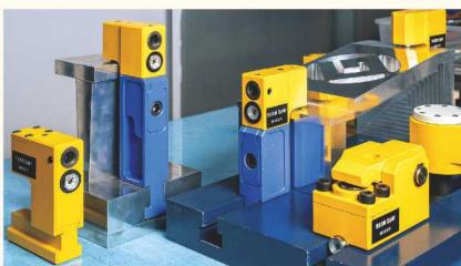
YELLOW CLAMPの製品群。さまざまな種類の金型に対応できるようにシリーズ展開している。全て内部のシリコンオイルを圧縮し、油圧の力で金型を固定する仕組み。
