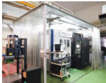
適正温度管理のもとで実験や製造を行えるように、空調装置を導入。一定の温度(±0.5℃)の環境下で行うようにした。
