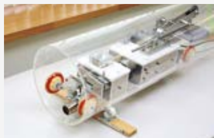
長岡工業高等専門学校との共同で開発した「断面形状測定装置」は、2014年に特許を取得。管内の亀裂や破損をTVカメラなどの目視で判断するのではなく、レーザーを照射して形状を図り数値化することで、より正確な調査を可能にした。
