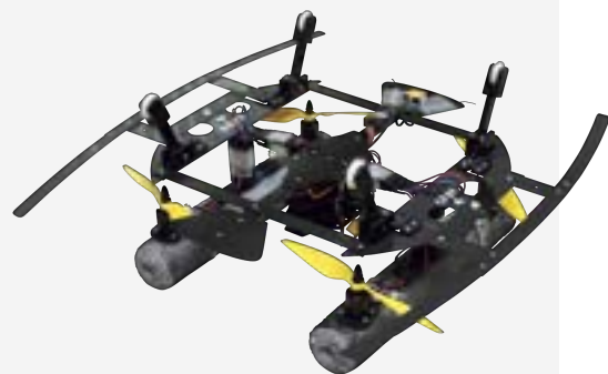
調査用ドローンの試作機。水に濡れないように下部にフロントを、管の内壁に当たってもダメージがないようにガードを装着している。天井面に張り付いて走行する技術は特許を出願中。高度な自立飛行を目指して今後も改良を進める。
